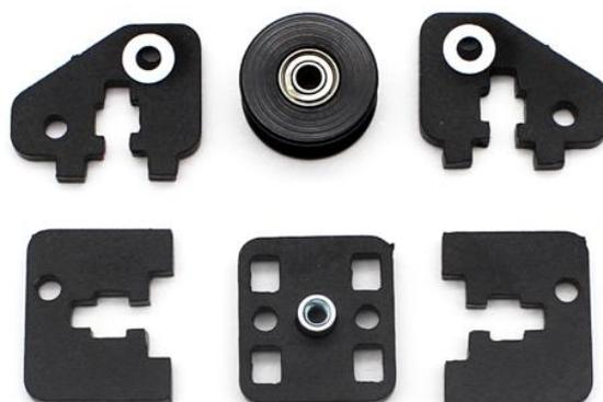
Сначала вставьте ролик между двумя пластинами, используйте шайбы М3, винт М3х20 и контр-гайку М3. Затяните винт так, чтобы ролик вращался свободно. Закрепите пластины с роликом винтами М3х12 к центральной детали с резьбовой заклепкой. Обратите внимание, заклепка должна выступать наружу, как показано на рисунке:
