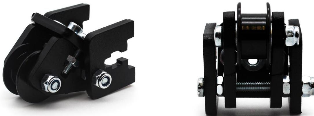
Закрепите натяжитель к передней стенке винтами М3х12
