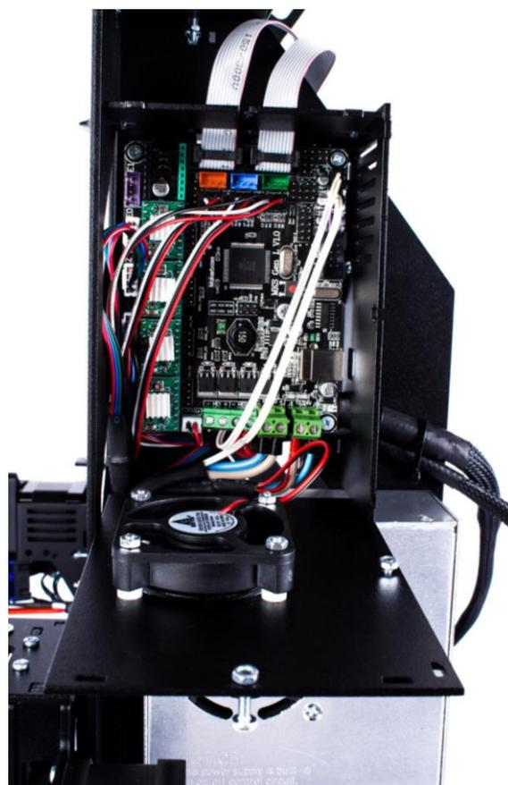
Вставьте разъемы шлейфа в EXP1 и EXP2 на дисплее (EXP1 и EXP2 на плате должен соответствовать EXP1 и EXP2 на дисплее). Установите крышку кожуха с вентилятором и прикрутите винтами М3х12
