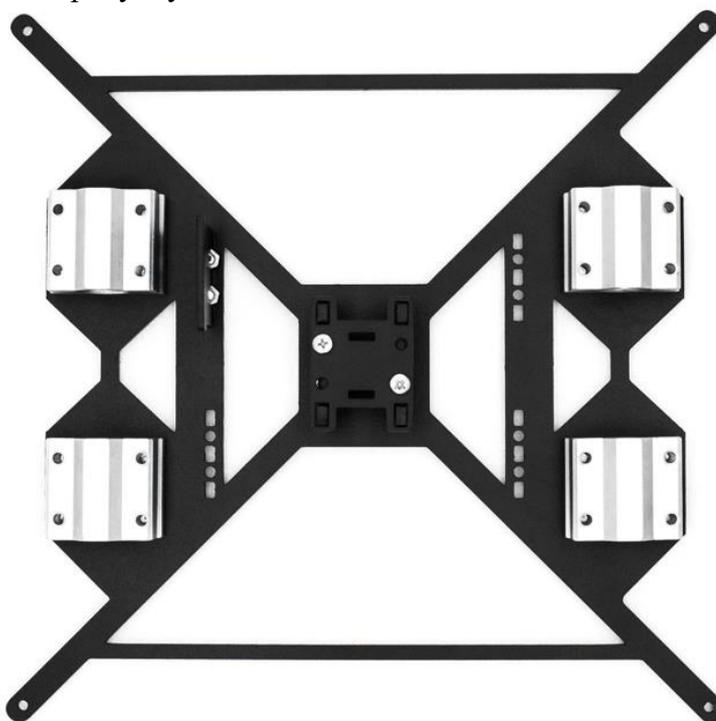
Установите каретку оси Y на раму. Вставьте 2 вала L=400мм через отверстия в передней стенке рамы, аккуратно проденьте валы через модули с подшипниками до упора в отверстия задней стенки. Зафиксируйте торцы валов при помощи пластин и винтов M3x12 с контр-гайками. Слишком сильно винты не закручивайте, можно легко нарушить геометрию вала и ход каретки будет затруднен. Проверьте ход каретки вдоль всей оси Y, затем докрутите до конца винты M4x8 на модулях каретки
