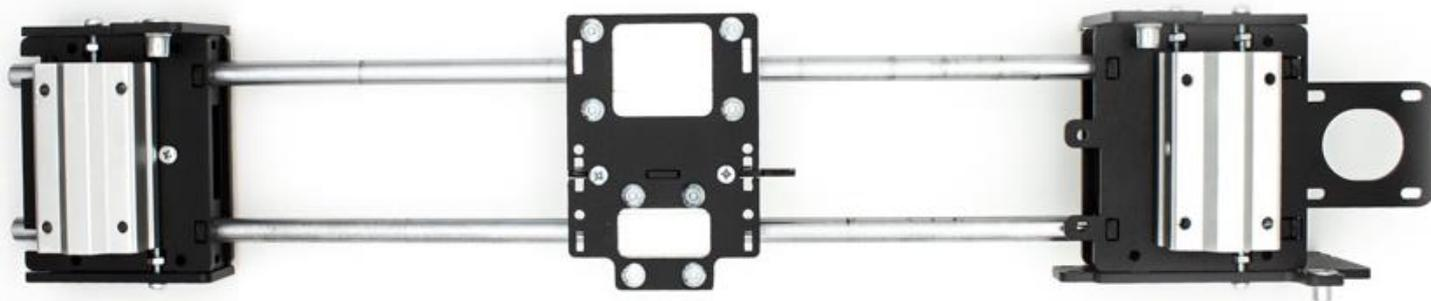
Затем установите собранный модуль на раму. Возьмите 2 вала L=400мм, вставьте их в отверстия в верхней пластине рамы и аккуратно просуньте через линейные модули в левой и правой каретке до упора с кронштейнами двигателей оси Z в нижней части
