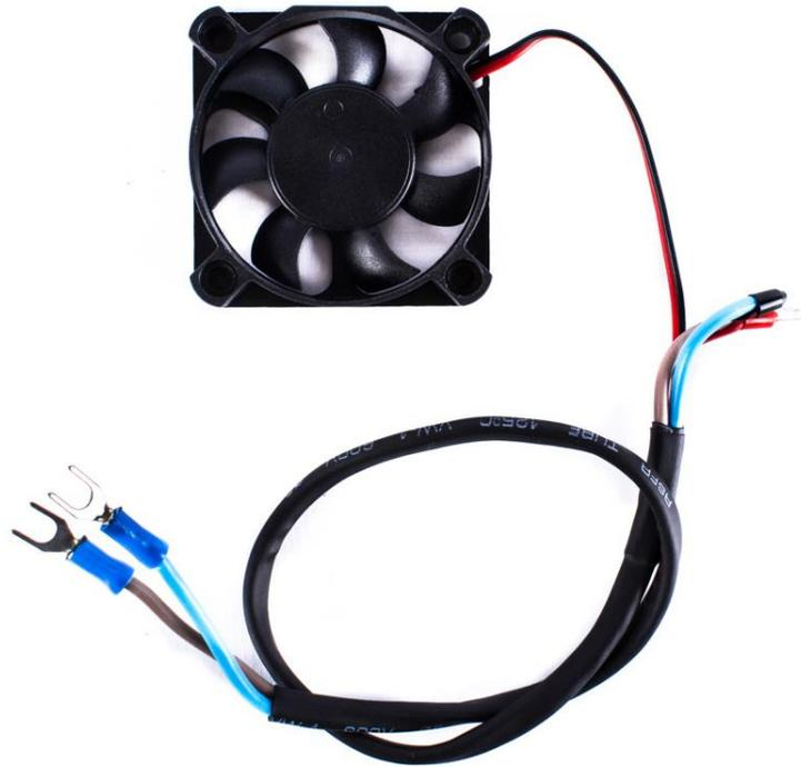
Подключите провод питания в разъем на плате MKS GEN «+12/24V». Соблюдайте полярность! (Провода могут отличаться по цвету, поэтому ориентируйтесь на цвет наконечника, красный всегда «+», а черный «-»). Шлицевой отверткой расслабьте прижимные винты на колодке, вставьте в них провода и закрутите. Вентилятор временно прикрепите стяжкой, чтобы не мешался.
