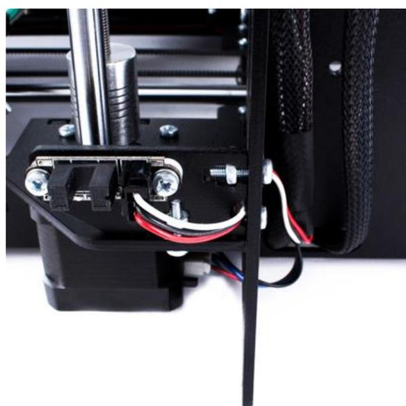
Протяните провод к левому двигателю оси Z и вставьте коннектор в разъем двигателя. Зафиксируйте провода стяжками, как показано рисунке
