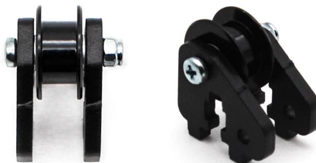
Теперь можно закрепить собранный модуль между двумя держателями, с помощью которых натяжитель будет крепиться к передней стенке рамы. Используйте винт М3х30, гайки М3 и контр-гайку М3. Сначала Винт М3 крепится к первой детали гайкой М3, контрится, затем надеваем зубчатый ролик, накручиваем гайку М3, но не сильно, чтобы ролик свободно вращался. Далее крепим вторую деталь и закручиваем контр-гайку М3, как показано на рисунке:
